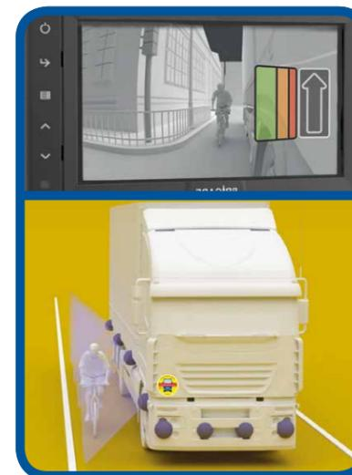
zu Tempo 30 stets in Bereitschaft ist. Setzt der Fahrer zum Rechtsabbiegen den Blinker, tritt das System in Aktion. Befindet sich dann ein Fußgänger oder ein Radfahrer im Gefahrenbereich, meldet sich der elektronische Assistent mit einem akustischen und einem visuellen Warnsignal auf dem Monitor.
