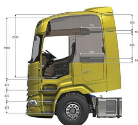
XG-Kabine: ebenfalls 2.690 Millimeter Länge, aber 13 Zentimeter weniger Innenhöhe.
