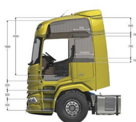
XF-Kabine: 2.590 Millimeter Kabinenlänge und extrem niedriger Einstieg.
