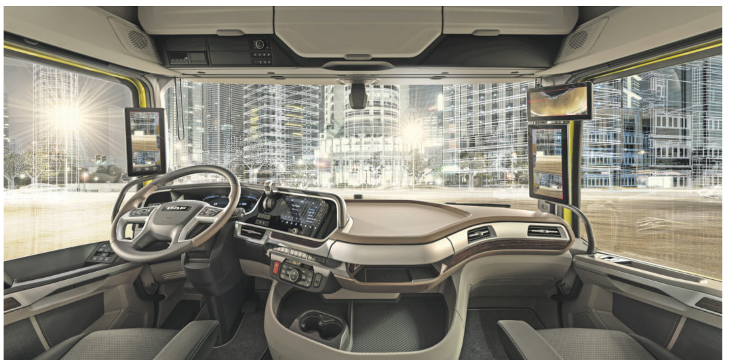
Neu und doch designtreu: Der XG-Arbeitsplatz mit optionalem Kamera-Spiegel-System, breiter Mittelkonsole mit großflächiger Center-Ablage und voluminösen Dachschränken.
