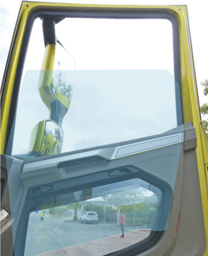
Trotz des Bordsteinfensters lässt sich die Seitenscheibe noch cirka 30 cm elektrisch senken (blau markiert). Das untere Innenfenster lässt sich übrigens zum Reinigen herausnehmen.
