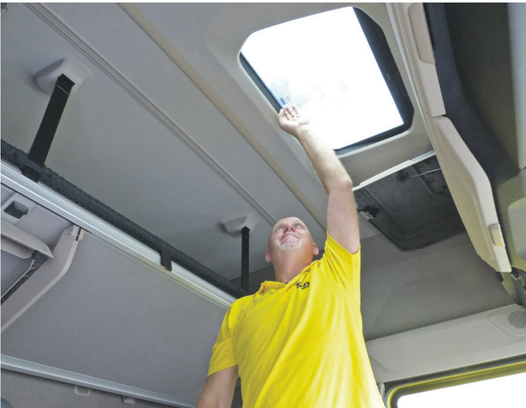
Die Höhe im XG+ -Haus ist enorm: 217 cm sind es über Mitte Motortunnel. Da haben auch Zwei-Mann-Besatzungen genug Luft zum Atmen, für den Einzelnen sind die 12,5 Kubikmeter umbauter Raum ein menschenwürdiger Lebensraum.
