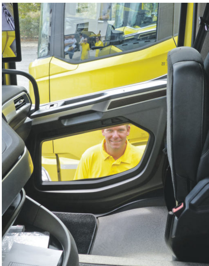
Klasse: Großes Bordstein-Fenster in logischer Kombination mit dem klappbaren Beifahrersitz. Hier sieht man wirklich, was neben der Kabine vorgeht.
